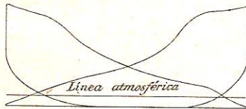
Fig. 212. — Diagrama doble obtenido con el indicador para ambas caras del émbolo.
